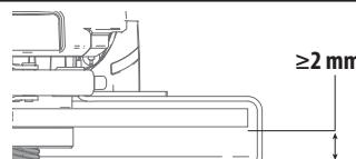
Bei allen Zubehörteilen zum Schleifen, Schmirgeln und Drahtbürsten muss sich der unterste Teil des Zubehörs innerhalb des Gehäuses der Schutzvorrichtung befinden, wobei der Abstand zur Unterkante der Schutzvorrichtung mindestens 2 mm betragen muss.
