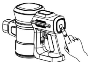
Triï el mode MIN/MID/MAX de l'aspiradora mitjançant el botó de velocitat per a les diferents condicions del sòl.
