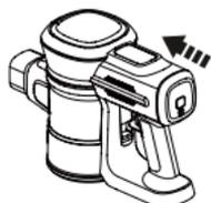
Deslice la batería en el cuerpo principal. La batería encajará en su posición cuando esté correctamente colocada.
