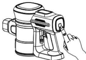
Elija el modo MIN/MID/MAX de la aspiradora mediante el botón de velocidad para las diferentes condiciones del suelo.
