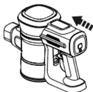
Llisqui la bateria en el cos principal. La bateria encaixarà en la seva posició quan estigui correctament col·locada
